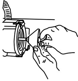
排水箱後ろのリンクレバーと連結している排水弁シャフト固定のフックを矢印の方向へ外し連結板より外してください。
