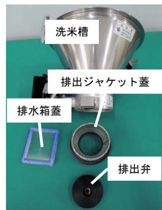
取り外した部品はシンクに移動させ、清掃ブラシなどで清掃してください。また、排出ジャケット蓋金網部、排出ジャケット内側、下部排水管内部は念入りに清掃してください。
