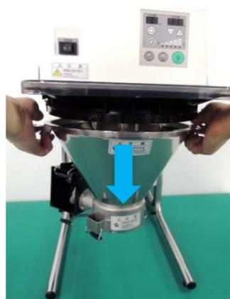
両手で洗米槽を下から支えて、洗米槽を取り外します。
