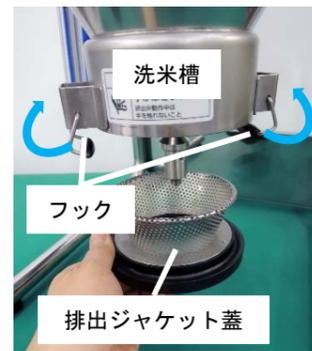
フックを外して、排出ジャケット蓋、排水箱蓋を取り外します。
