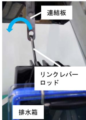
排水箱後部にあるリンクレバーロッドと連結板を外します。
