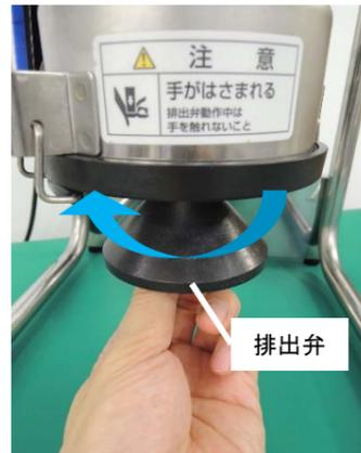
排出弁開閉スイッチを押して、排出弁を開けます。電源スイッチをOFFにし、排出弁を取り外します。
